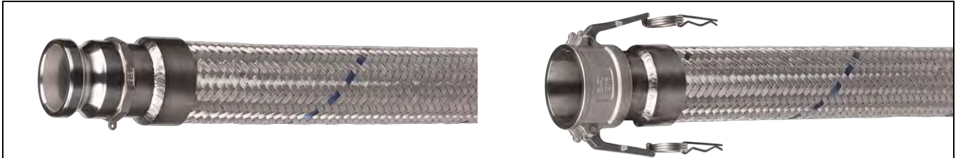
Приклад промислових з'єднувачів, приварених безпосередньо до сталевих шлангів. Зліва: PARNOR DN50 з муфтою CAMLOCK (2" ніпель) зі сталі AISI 316 (AC-FW-200-SSX). Справа: PARNOR DN50 з муфтою CAMLOCK (2" гніздо) зі сталі AISI 316 (AC-BW-200-SSX). Обидві муфти CAMLOCK мають зварювальний кінцевик який встик і приварюються безпосередньо до шлангу. Див. розділ АРМАТУРА ПРОМИСЛОВА, розділ „З'єднання CAMLOCK”.
