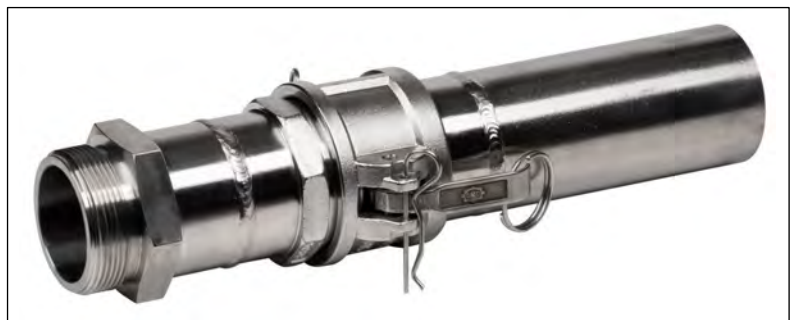
Муфта з'єднувальна мамка CAMLOCK приварюється встик до безшовної труби EN 10216-2 (номенклатура труби: MPR-RBSZ-060X2.9-SS321) зі сталі AISI 321.
