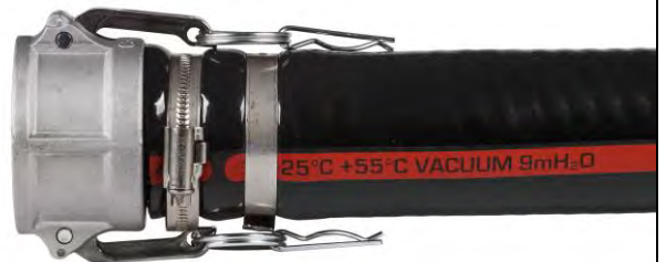
Шланг VACUPRESS OIL DN50 зі з'єднанням CAMLOCK 2" (AC-C-200-AX) з алюмінію, змонтованим за допомогою двох черв'ячних хомутів з нержавіючої сталі (AB-03017543). AISI 316.
