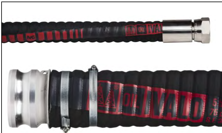
Шланг IVALO DN25 з гідравлічний фітінг з внутрішньою різьбою 1" BSP з нержавіючої сталі AISI 316 (TI-ZBW110-16-16-SS) з втулкою (TI-L-37-16-SS) з нержавіючої сталі AISI 304 і IVALO DN76 з роз'ємом CAMLOCK E 3" з алюмінію (AC-E-300-A), змонтованим за допомогою хомутів (AB-03009009) з оцинкованої сталі.
